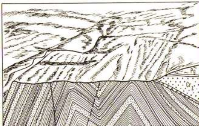
6-nji surat. Iri epilme strukturalary ýer üstüne çykanda emele gelýän monoklinal gatlarlar.
